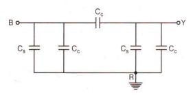
$$C_{BY} = \frac{C_S + C_C}{2} + C_C = \frac{C_S + 3C_C}{2}$$
